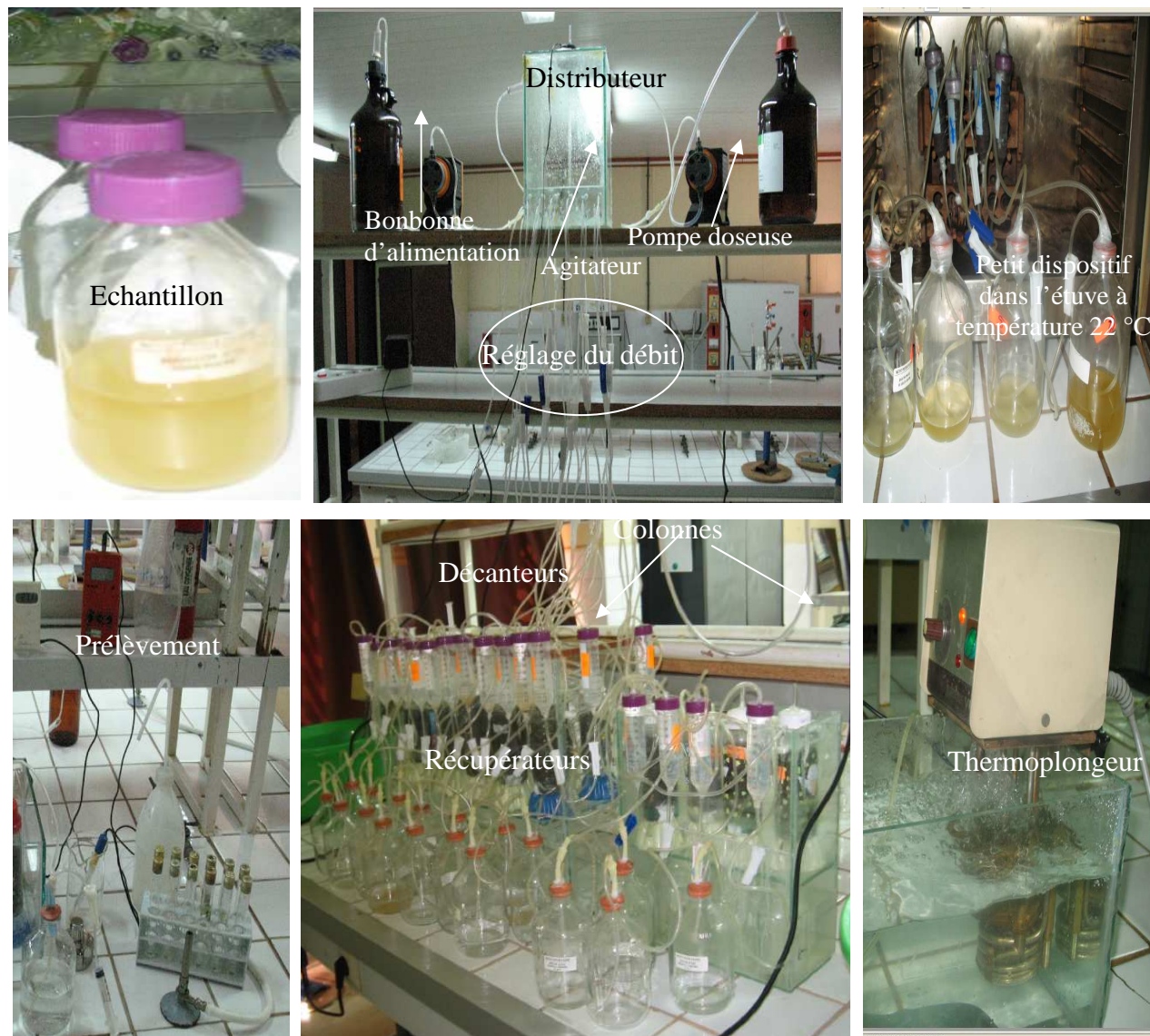
Photo 3 : dispositif de fermentation en continu sur support pouzzolane.
