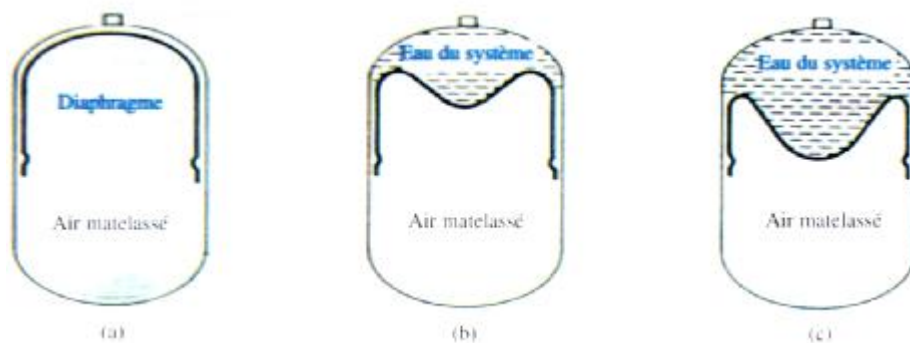
Figure III.5 : Principe de fonctionnement du vase d'expansion [06].
