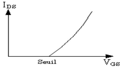
Figure II.11 : Caractéristique de transfert du MOS canal N.
