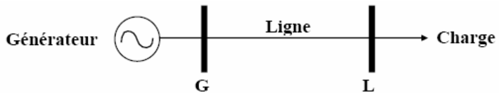
Schéma unifilaire d'une transmission de puissance simple
