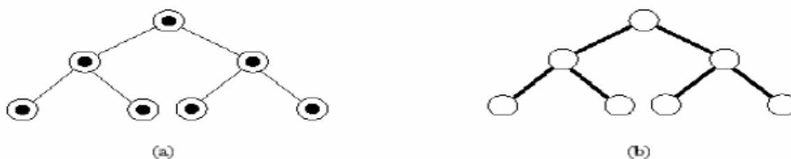
Figure 5.1 Pistes de phéromone peuvent associées (a) aux composants (b) ou aux connexions.
