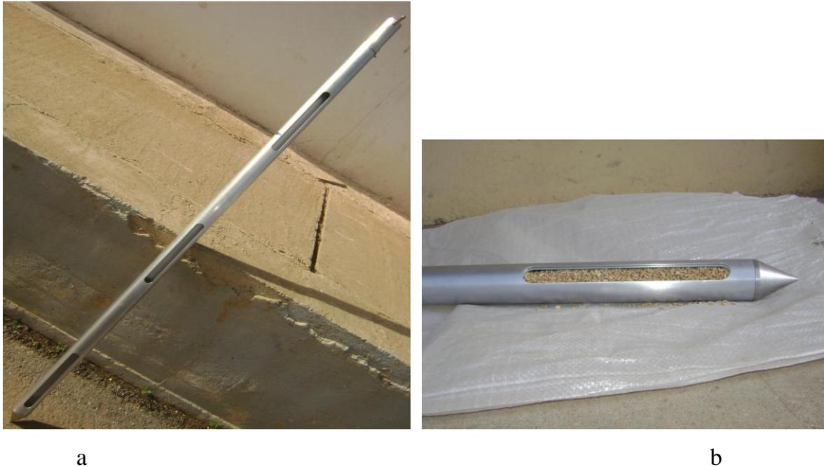
Figure IV.14 : Sonde d'échantillonnage
