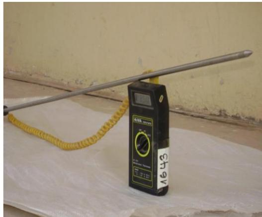
Figure IV.12 : Thermomètre, HI 8757
